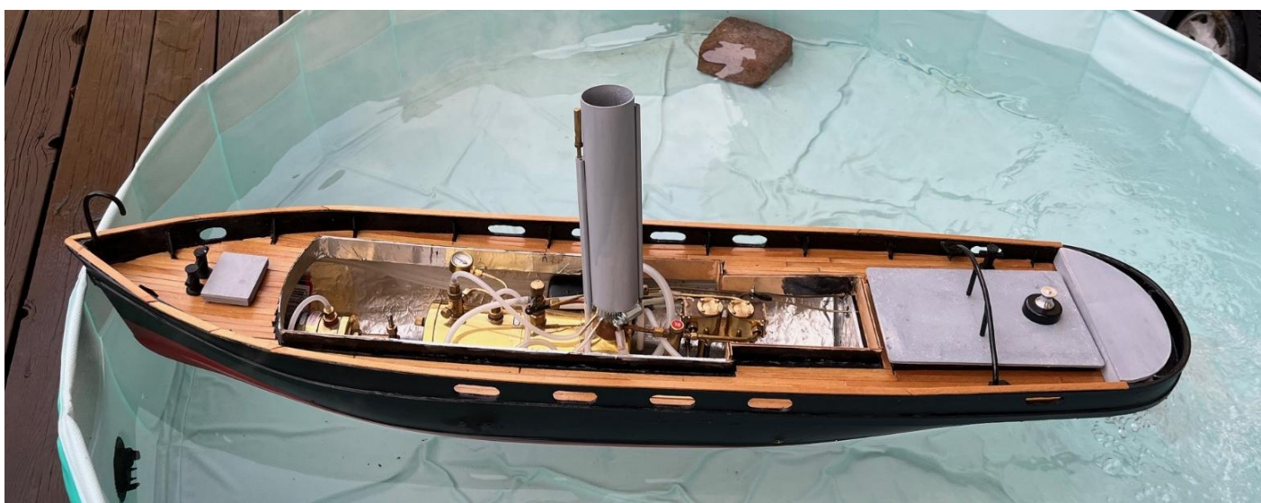
Laitaa vasten osapaineella. Poistoputket toimivat moitteettomasti, potkuri pyörii ja vesi virtaa.
