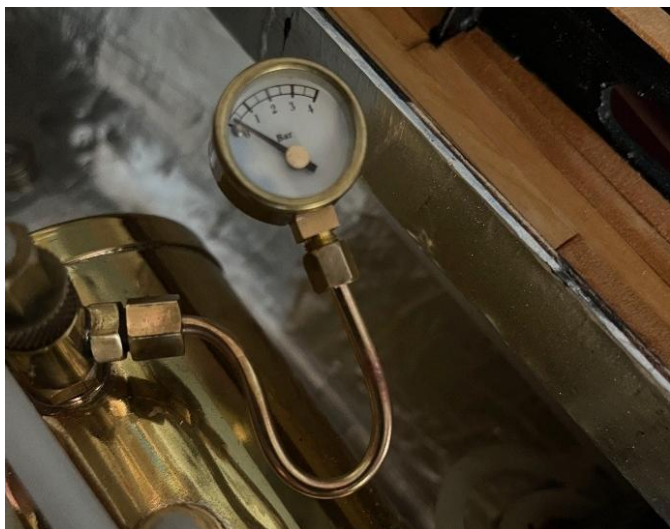
Manometri ja mekaanisen vivuston kollarit avarruksessa.
