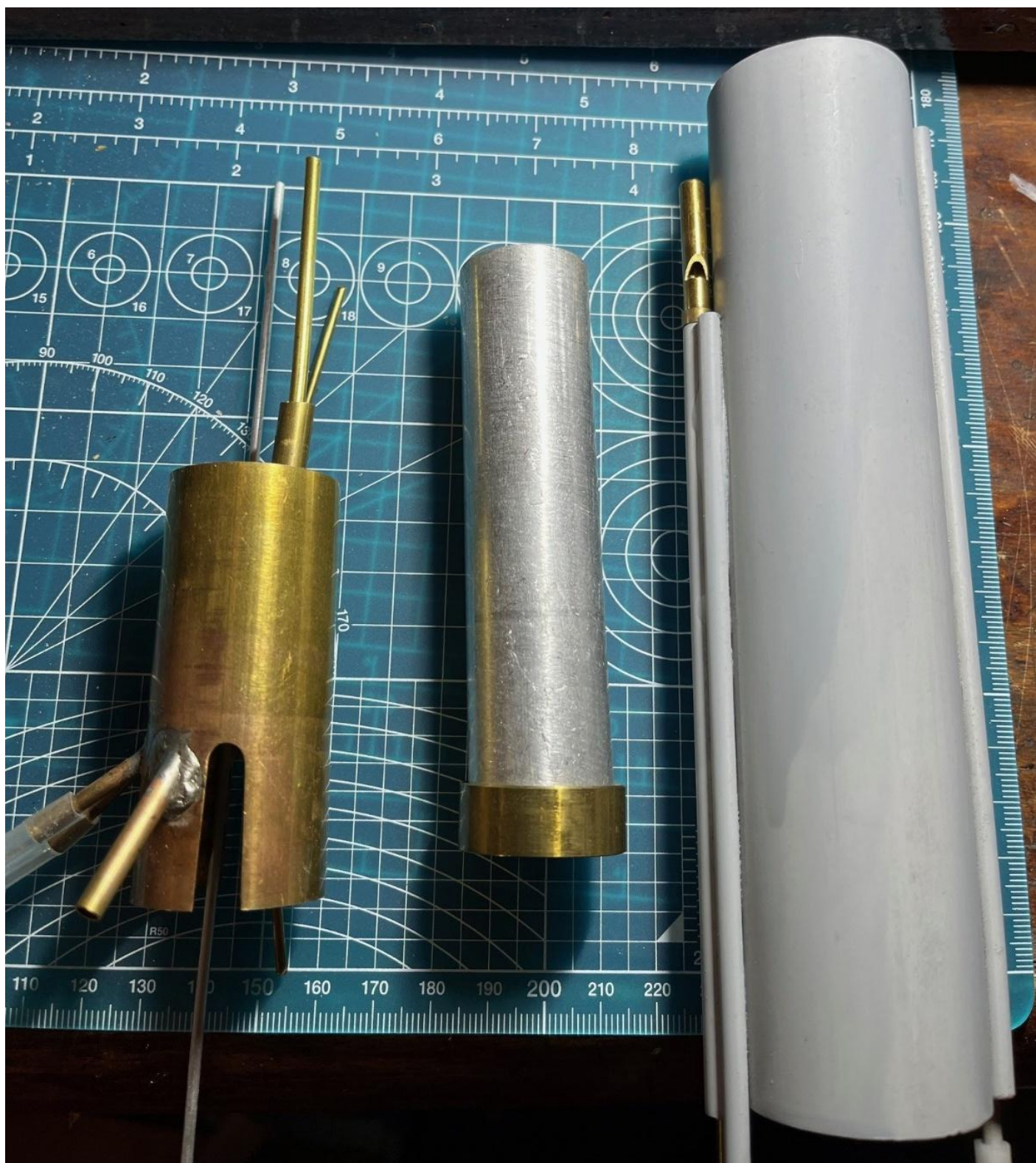
Korsteenin rakenne oikealta: välipiippu, sisäpiippu ja lähes lopullisessa asussa pohjamaalattu ulkoapiippu (pilli pyörähtänyt)
