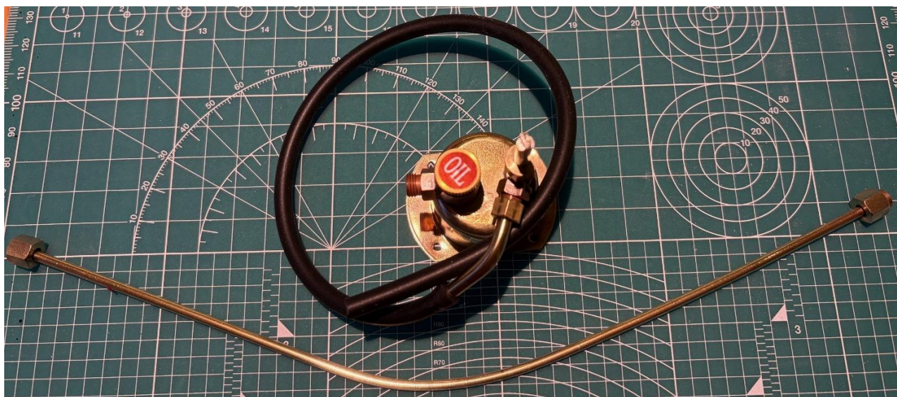
Savunestetankki höyryputkineen syöttää höyrystimelle esilämmitetyn savunesteen.
