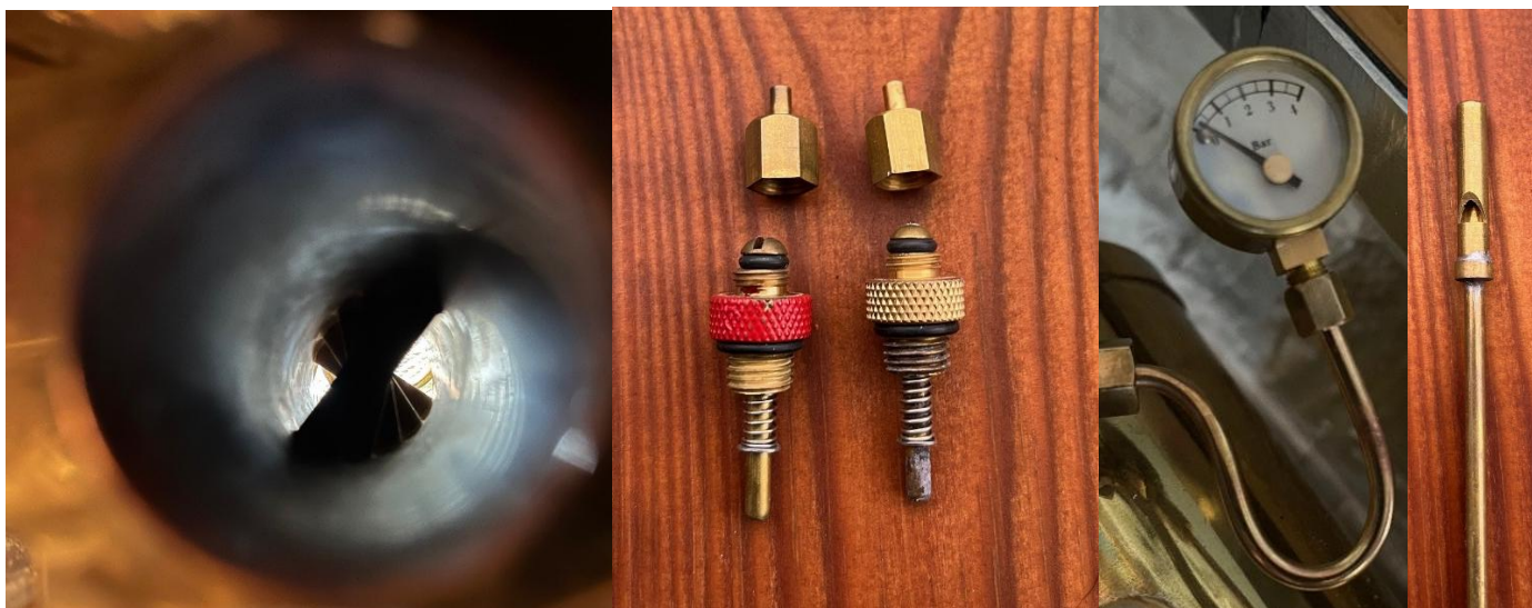
Kattilan spiraaliputket, varoventtiilit, manometri ja höyrypilli
