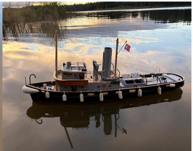
Ensimmäiset koeajokuvat järvellä. Poltin kohisee jo. Kone lämmitetty. Vielä hetki niin kattilassa paine riittäisi ajoon.
