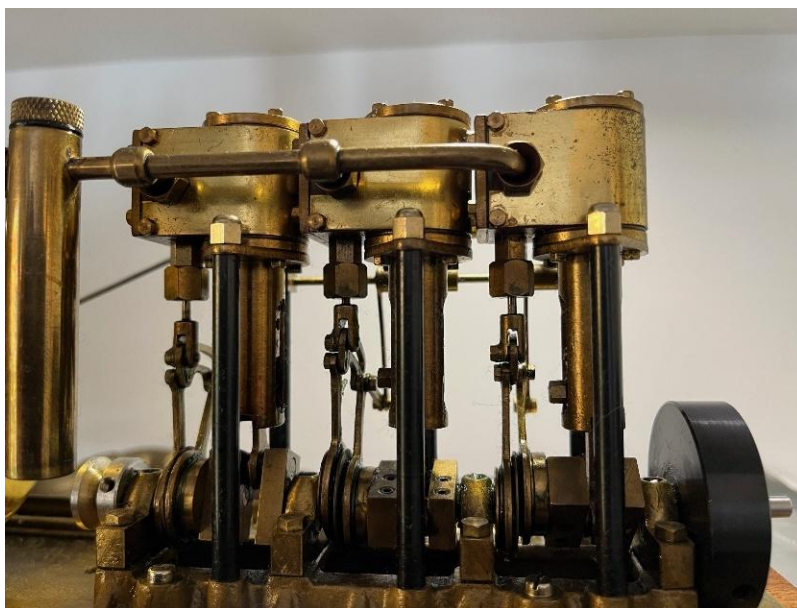
Saiton kolmisylinterinen TD3R ja kaksisylinterinen TD2R höyrykone
