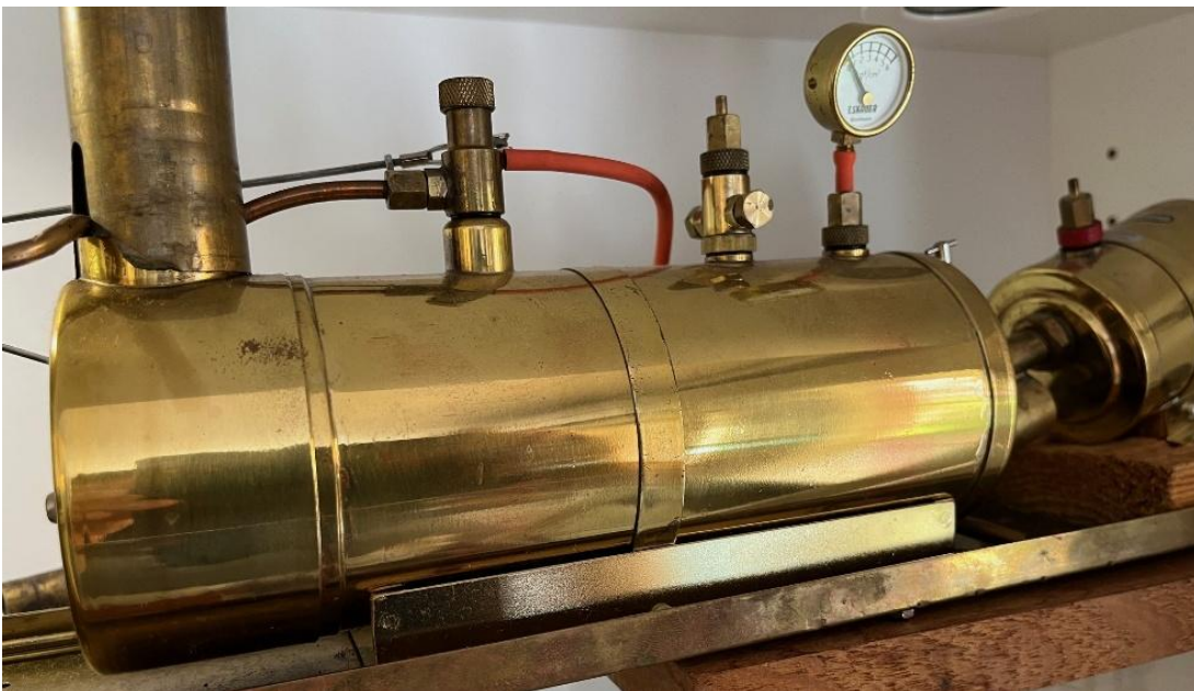
Joskus 90-luvulla puuhasteltu Saiton Polar Starin voimanlähteiksi tarkoitettu kolmisylinterinen osista kasattu TD3R(A) kone ja B3 kattila
