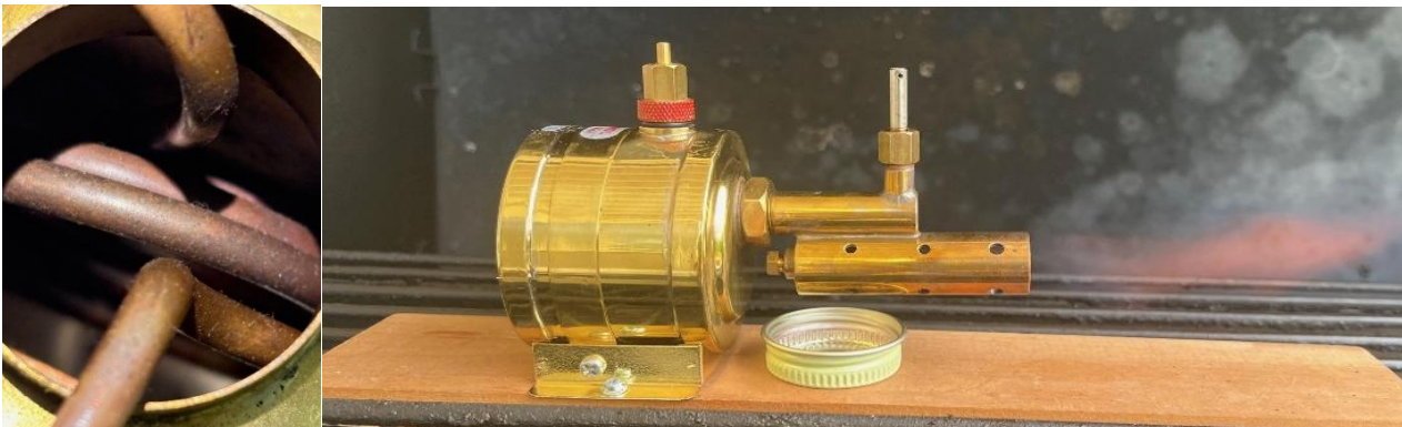
Pannun tulistinkierukka sekä poltin koekäytöllä. Poltin tarvitsee joka käytön jälkeen yksinkertaisen mutta haastavan suuttimen puhdistuksen. Kiristysrengas telineeseen olikin liimattu, ei juotettu.
