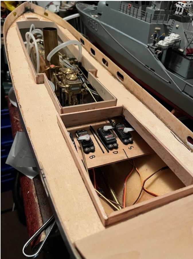
Kannen ja partaiden tekoa ennen lankutusta. Tapa, joka lopputuloksenkin vuoksi jättää tämän rakennussarjan valmistajalle toivomisen varaa.
