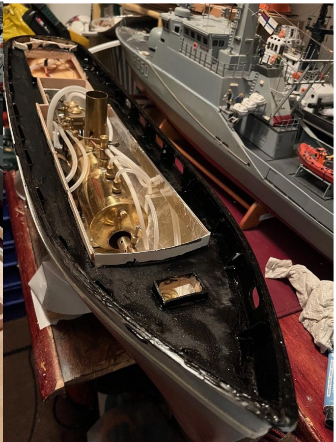
Kannen ja partaiden tekoa ennen lankutusta. Tapa, joka lopputuloksenkin vuoksi jättää tämän rakennussarjan valmistajalle toivomisen varaa.
