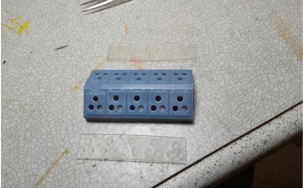
Skailetti ja sen sisälle tarkoitettu osa joka sisälsi kaikki ikkunat.
