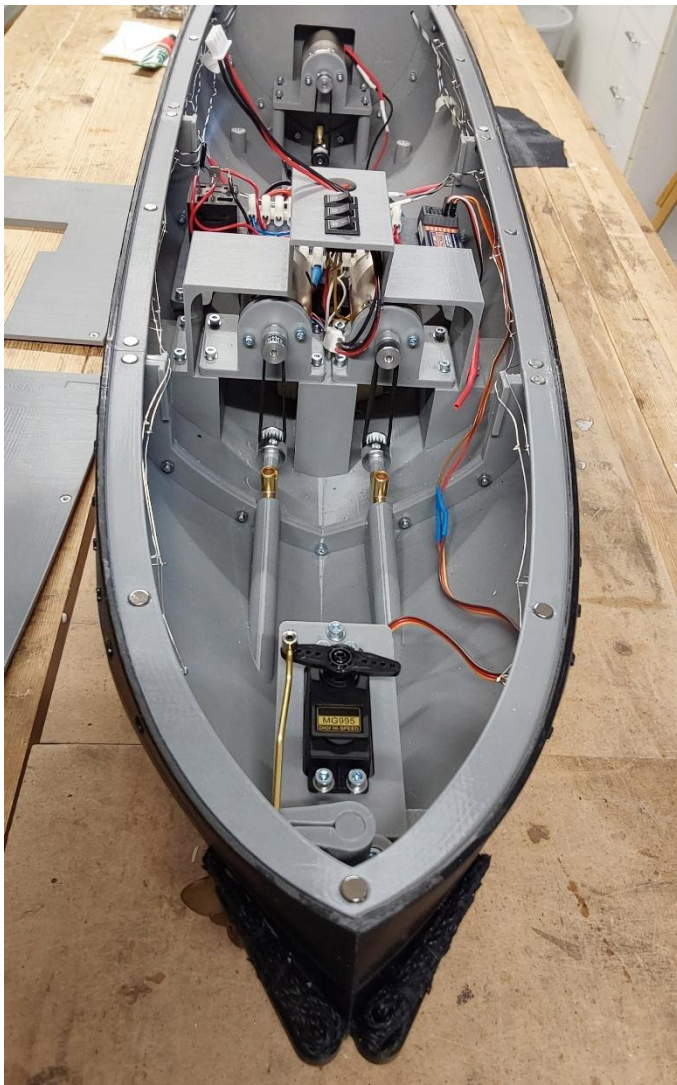
Rungon puolen magneetit, kuvasta näkyy selvästi että ne ovat jonkin verran kohollaan partaan tasopinnasta.
