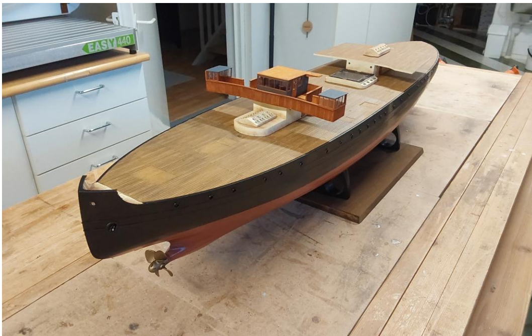
Suurimmat kansirakenteet paikallaan ja detajlien lisääminen malliin voi alkaa.
